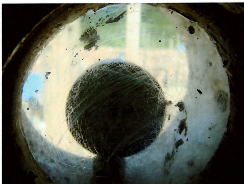
Figura 38 – Dificuldade de se verificar o manômetro. Fonte: AUTOR, 2009
