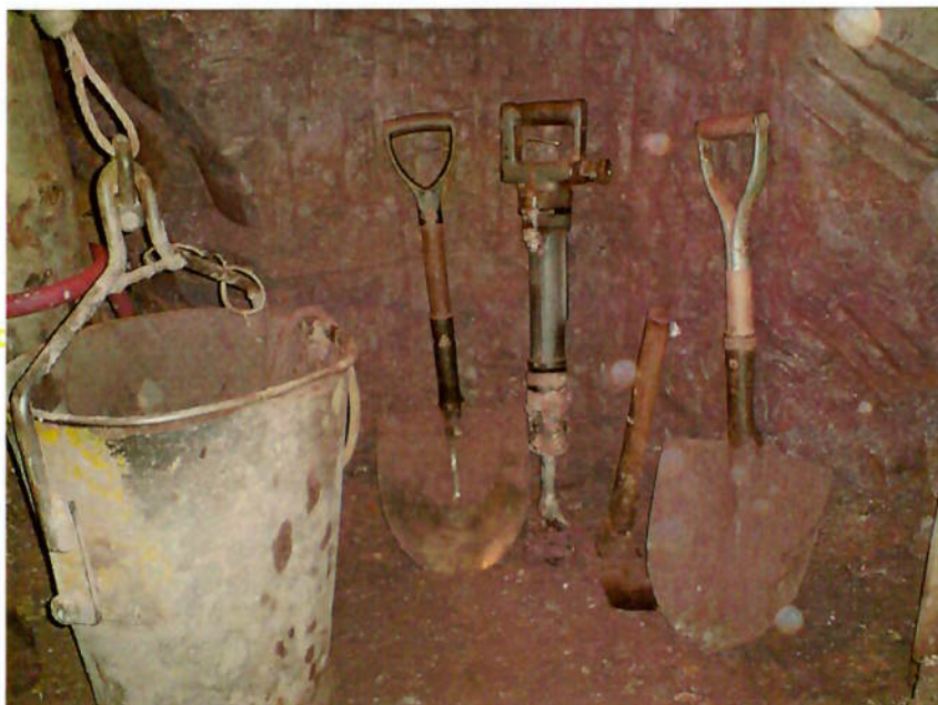
Figura 31 – Material utilizado para escavação do tubulão Fonte: Autor, 2008
